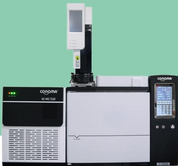
配置 24 位自动进样器可实现双塔进样
